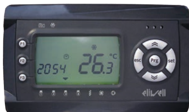
Terminal SKP22 con display LCD sin retro-iluminación
